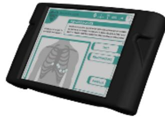
Le sue funzionalità consistono nella registrazione di elettrocardiogrammi (ECG) tramite degli elettrodi collegati al dispositivo stesso, e nel loro successivo invio ad una piattaforma cloud tramite connessioni Internet mobile.
